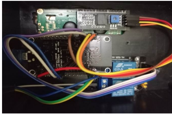
Gambar 2. Implementasi NodeMCU ESP8266
